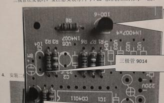
晶闸注意管,不要和 三极管混淆, 也要注 意安装的方向与电 路板的标示一致。
